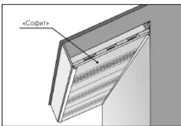
с. В направляющие профиля вставляются панели и фиксируются при помощи саморезов к обрешетке.
