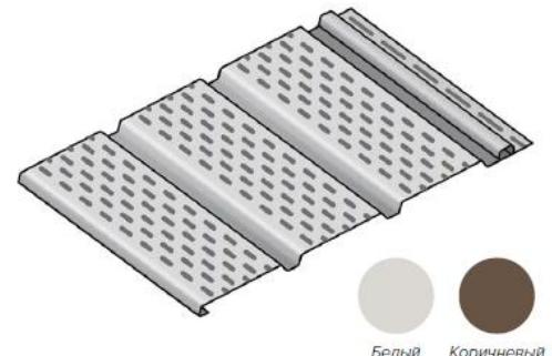
Используются для лучшей циркуляции воздуха в подкровельном пространстве (карнизы и фронтоны). Перфорированные софиты устроены таким образом, чтобы обеспечить наилучший приток воздуха в вентиляционный зазор, а также защитить подкровельное пространство от проникновения птиц и насекомых. Обеспечивают долговечность кровли.
