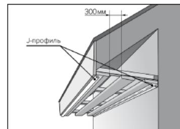
б. На бруски смонтировать обрешетку. В качестве обрешетки рекомендуется использовать доску 100 x 25 мм. По краям свеса монтируется направляющий профиль (J-профиль).
