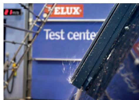
Надежная воздухо- и водонепроницаемость подтверждается проверкой в аэродинамической трубе.
