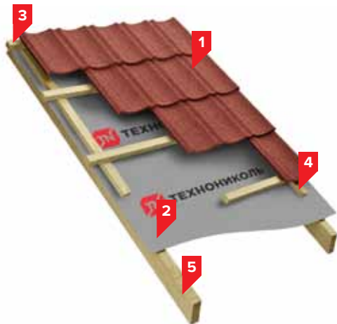
Рис. 5. Строение кровельной системы ТН-ЛЮКСАРД Классик.
