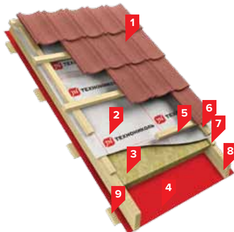
Рис. 6. Строение кровельной системы ТН-ЛЮКСАРД Мансарда.
