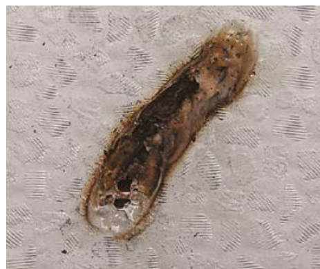
Образец мембраны толщиной 1,2 мм после проведения испытания.
