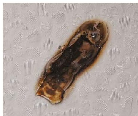
Образец мембраны толщиной 1,5 мм после проведения испытания.
